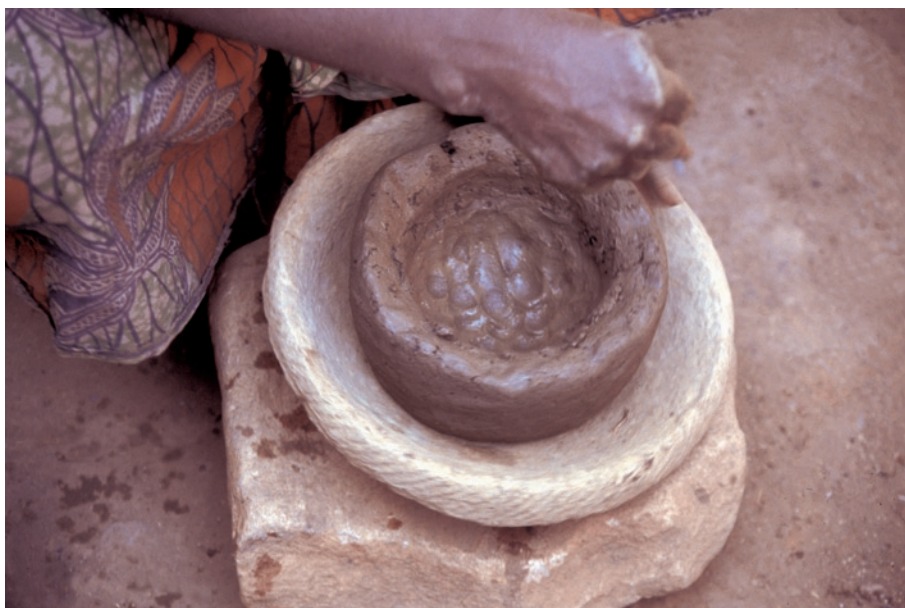
Photo : 13. Dégui. Potière A. Kassambara (Yanogué) (5854, tradition D). Ebauchage. Phase modelage et creusage d'un cylindre (M). Creusage du cylindre avec le poing. Montage 288. Photographie 364-12, Y. Kalapo.
