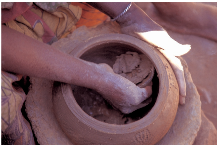
Photo : 22. Dégui. Potière A. Kassambara (Yanogué) (5854, tradition D). Finition. Phase rabotage interne (Rint). Amincissement de la paroi de la poterie par rabotage de l'intérieur de la panse avec une demi-noix de ronier. Montage 288. Photographie 365-17, Y. Kalapo.
