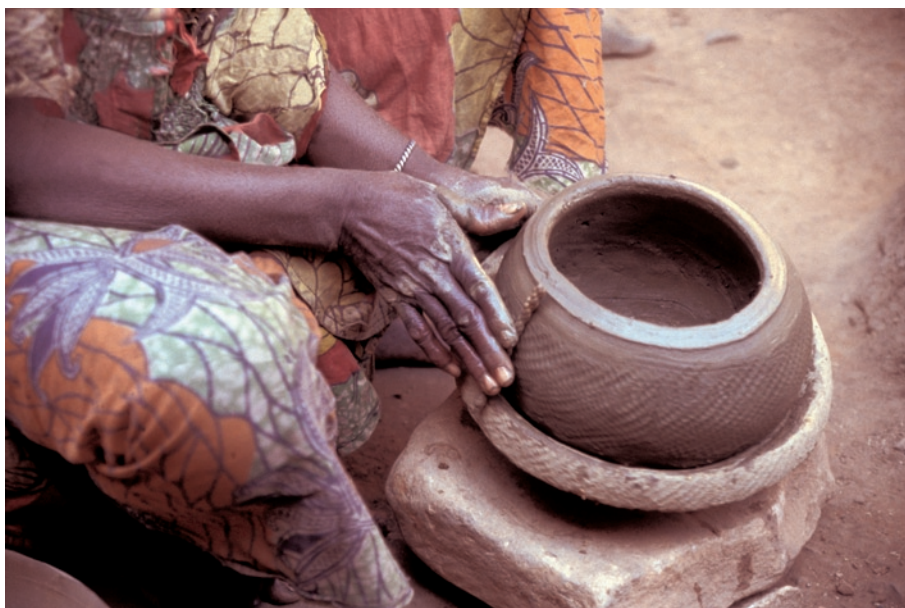
Photo : 25. Dégui. Potière A. Kassambara (Yanogué) (5854, tradition D). Finition. Phase impression à la cordelette roulée (Cord). La cordelette est appliquée sur la surface externe alors que la main gauche fait lentement tourner la coupelle d'argile crue posée sur la meule. Montage 288. Photographie 365-6. Y. Kalapo.
