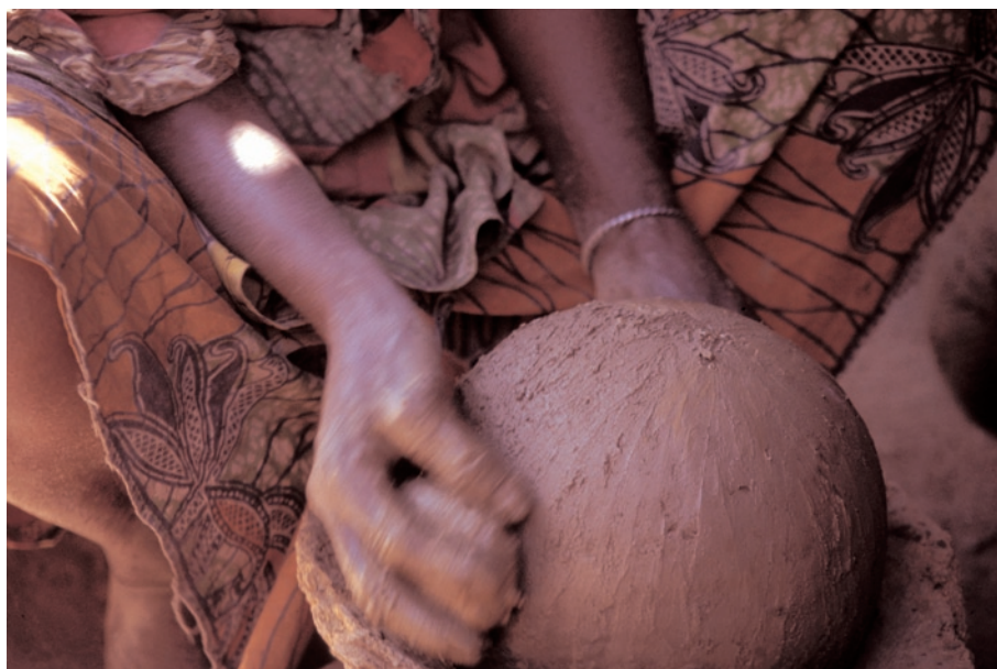
Photo : 24. Dégui. Potière A. Kassambara (Yanogué) (5854, tradition D). Finition. Phase lissage externe (Lex). Lissage de haut en bas de la surface externe enduite d'argile molle avec un galet. Montage 287. Photographie 364-3, Y. Kalapo.
