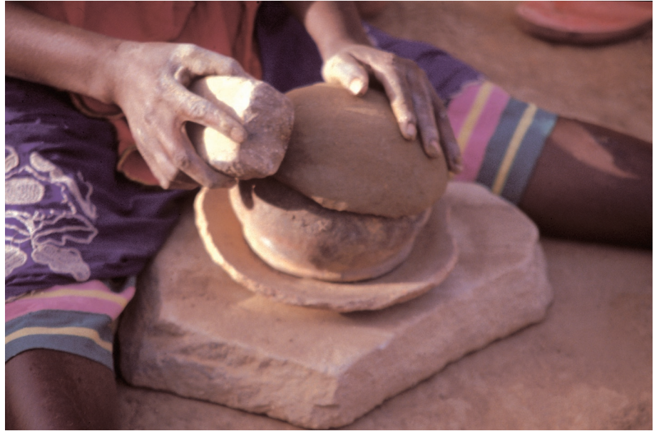
Figure 20. Néné. Concession C1. Tradition C. Montage sur fond retourné. Martelage au percuteur de pierre d'une plaque d'argile posée sur une poterie retournée. Le dispositif de montage comprend une poterie retournée sur une coupelle reposant elle-même sur une meule. Potière H. Arama (Arama) (fiche 5509). Photographie 348.20
