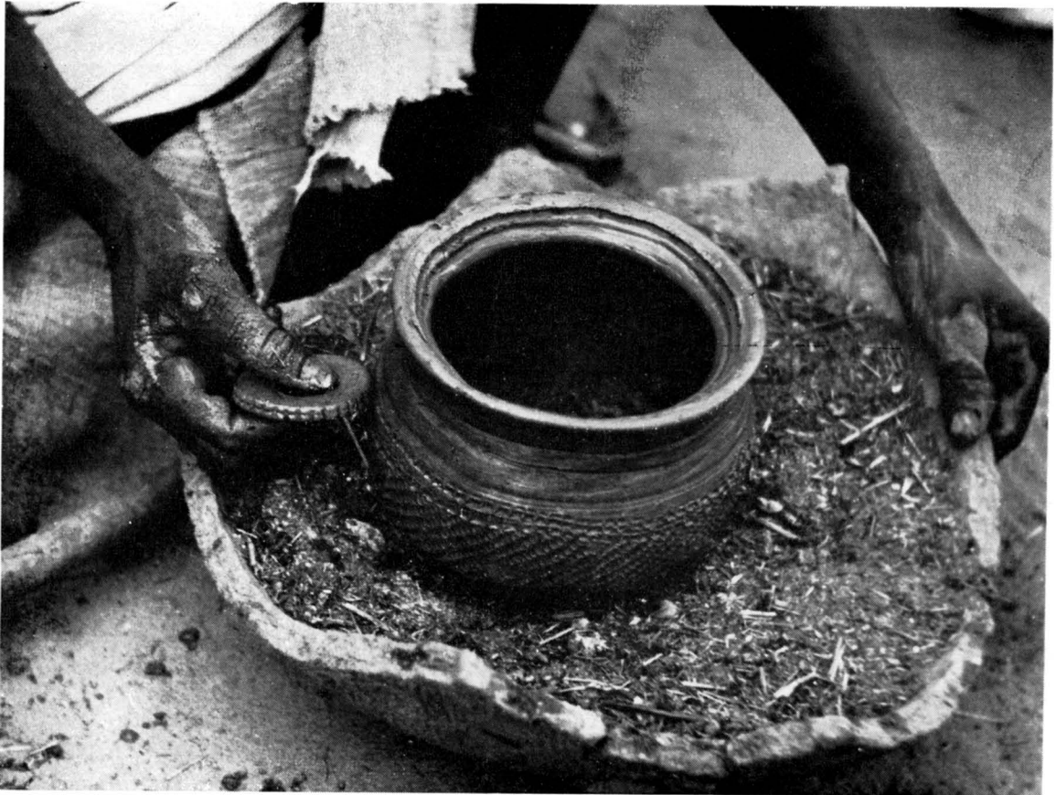
3. Goumbou. 21.I.65. Potière Yougoundo Kamara. Décoration au moyen de la rondelle dentée. La main droite reste fixe tandis que la main gauche entraîne le gros tesson servant de tournette dans un mouvement circulaire lent et continu de droite à gauche par rapport à la potière.
