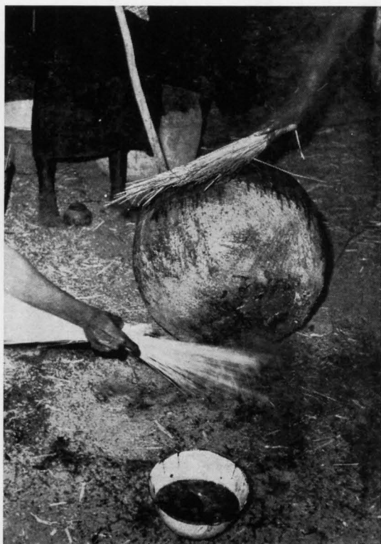
3. et 4. Idem. Les grandes poteries qu'on ne peut pas tremper sont flagellées avec les balais de paille trempés dans le bachi . Après avoir séché près du tas de cuisson, les poteries sont entreposées un peu à l'écart.
