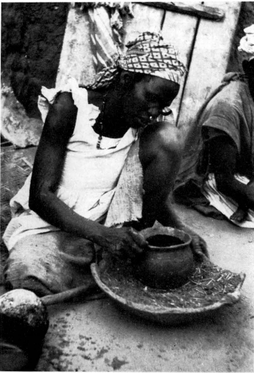
1. et 2. Goumbou. 21.I.65. Potière Yougoundo Kamara. Montage d'une petite poterie. Modelage du bord à la tournette. Instruments de la potière : poterie retournée enduite de cendre (moule pour les fonds), filet, plat de bois contenant un fragment de cuir, 2 lissoirs et une rondelle dentée ( feren ).
